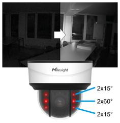
Bei schlechten Lichtbedingungen, zum Beispiel nachts, schaltet die Kamera automatisch in den Schwarz/Weiß-Betrieb um. Die Sicht wird zusätzlich durch die integrierte Infrarotbeleuchtung mit einer Reichweite von bis zu 160 Metern unterstützt.
